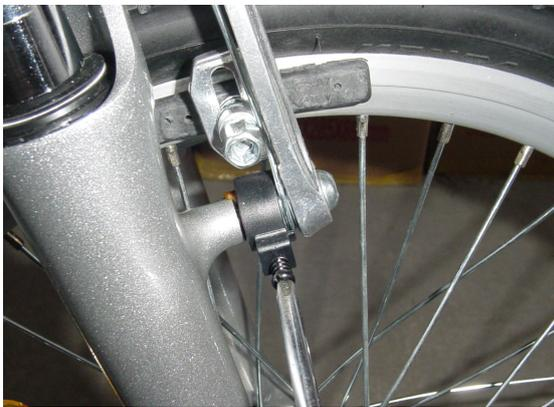
La tension des ressorts de rappel doit être la même de chaque côté pour un réglage optimum (sinon un des deux patins risque de frotter sur la jante)
