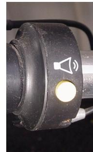
/ en position enfoncé, il est fermé (le multimètre affiche quasiment 0)
