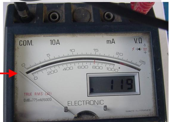
en actionnant le levier de frein, il est fermé (le multimètre affiche quasiment 0)
