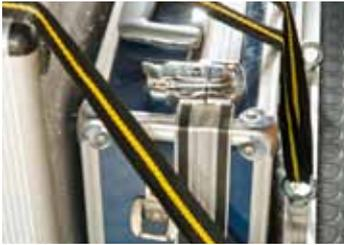
La soute est pourvue de **rails et de crochets d'arrimage** pour fixer solidement vélos ou scooter.
